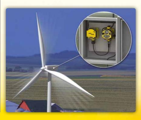
的SureCross节点可以收集多种 数据类型, 然后经由无线回传至位于中 控室内的网关。
